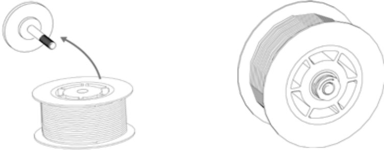
Рис. 8.4.4. Установка катушки типа D100.
