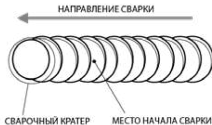
Рис. 11.2.2. Начало сварки при смене электрода.
