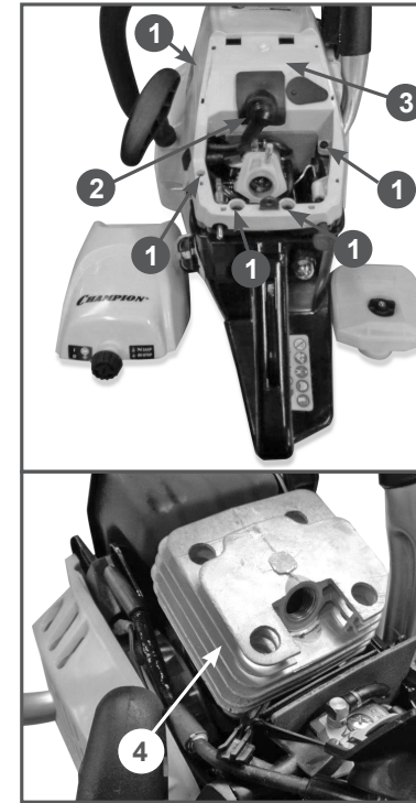
Рис. 23 Очистка охлаждающих ребер цилиндра
