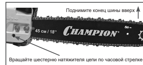
Рис. 5 Регулировка натяжения цепи
