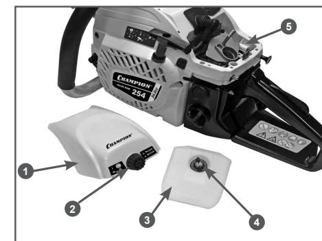
Рис. 21 Обслуживание воздушного фильтра
