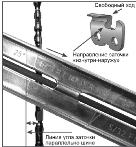
Рис. 28 Определение угла заточки
